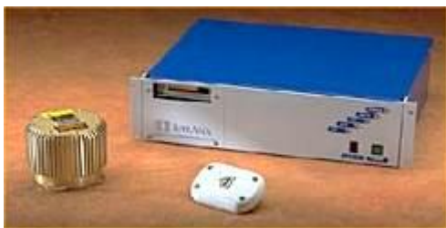
FIG. 04 - SISTEMA DE MEDIÇÃO INERCIAL E SEUS COMPONENTES
